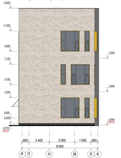
Фрагмент фасада в осях 5/А-Д
