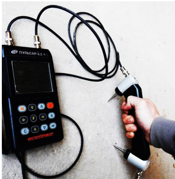
Рис. 1. Определение прочности бетона строительных конструкций неразрушающим методом с помощью прибора Пульсар 2.2
