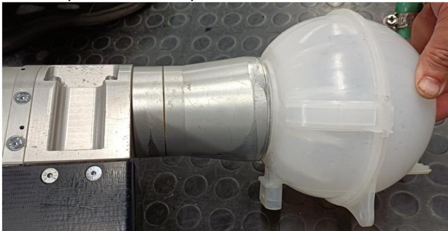
При смене типа расширительного бачка также изменились размеры заливной горловины бачка, при этом в целом конструкция расширительного бачка не изменилась:
