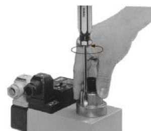
2. Плавно поворачивая ручку регулятора расхода газа в сторону «+» - увеличение расхода, или «-» - уменьшение расхода, добейтесь требуемого расхода, сверяясь с показаниями счетчика.
