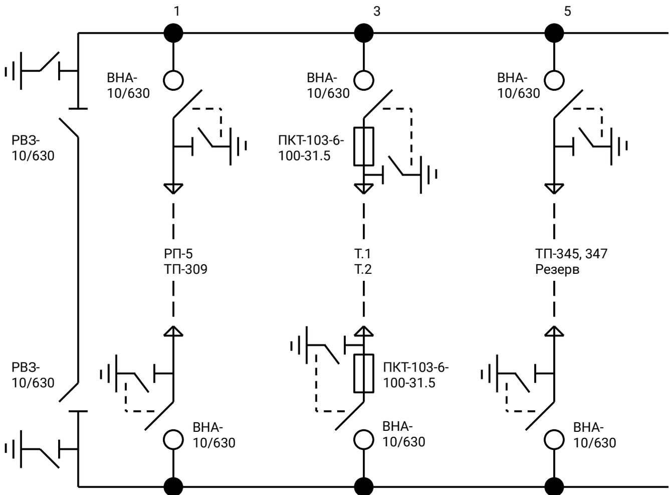
1. В камерах КСО № 1, 2, 3, 4, 5, 6 выполнить спуски из-под ВНА шинами с использованием опорных изоляторов (для подключения кабельных линий)
