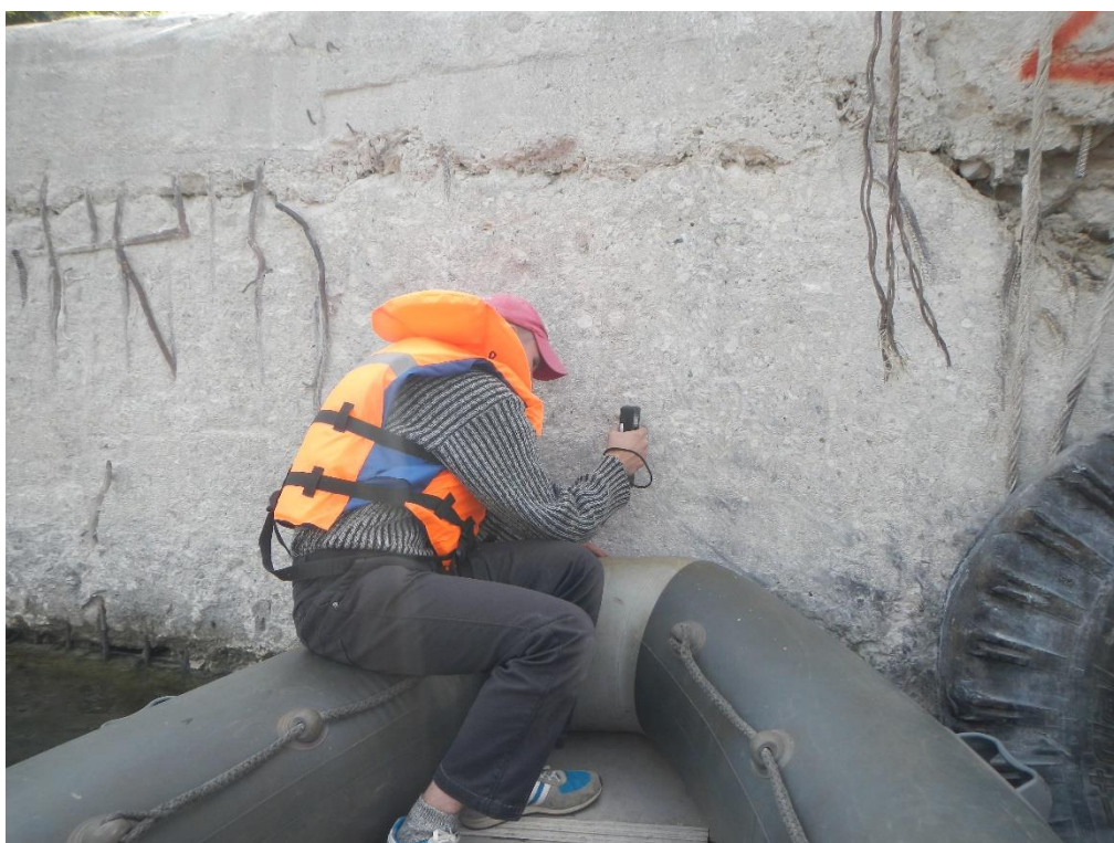
Определение прочности бетона ультразвуковым методом
