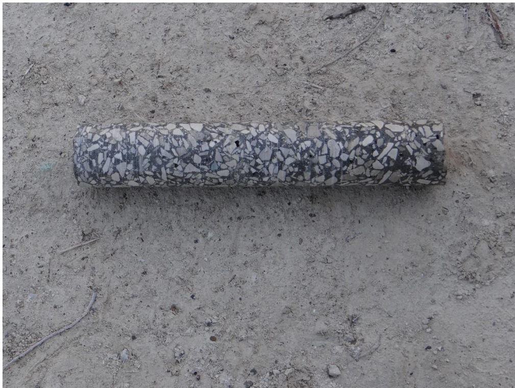
Общий вид выбуренного керна
