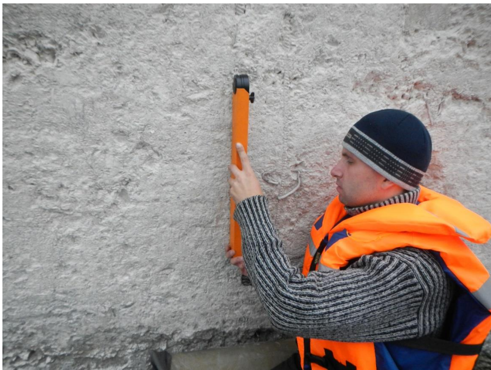
Измерение наклона верхнего строения
