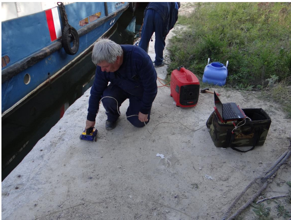
Георадиолокационные исследования на грузовом причале
