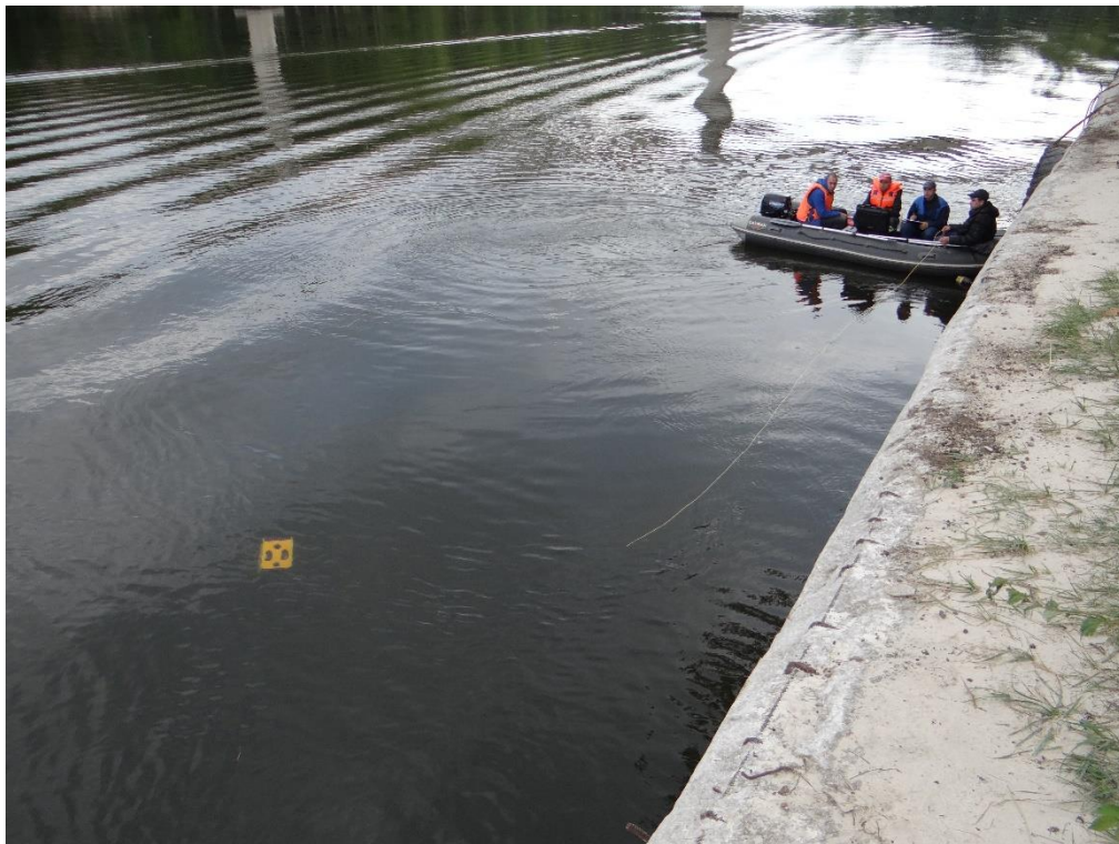
Обследование подводной части причала с помощью подводного телеуправляемого осмотрового комплекса «ГНОМ Стандарт»
