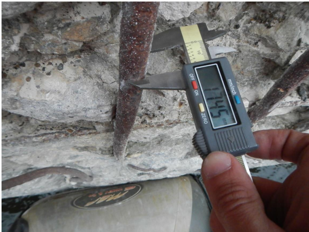
Измерение диаметра арматуры
