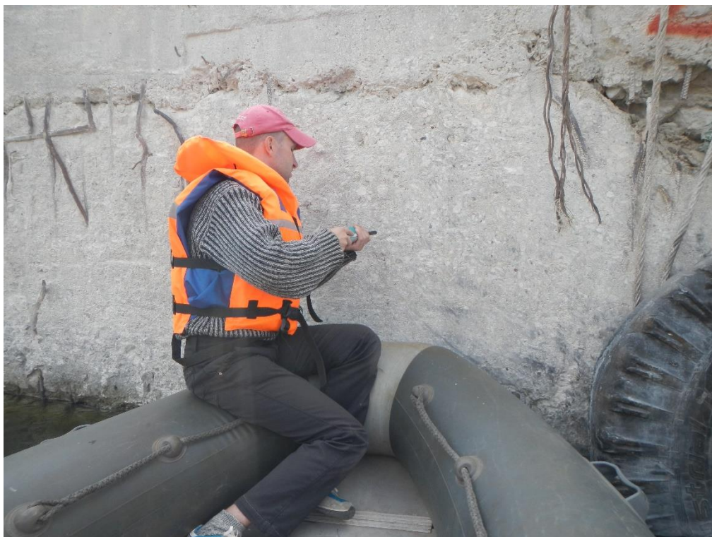
Определение прочности бетона Молотком Шмидта
