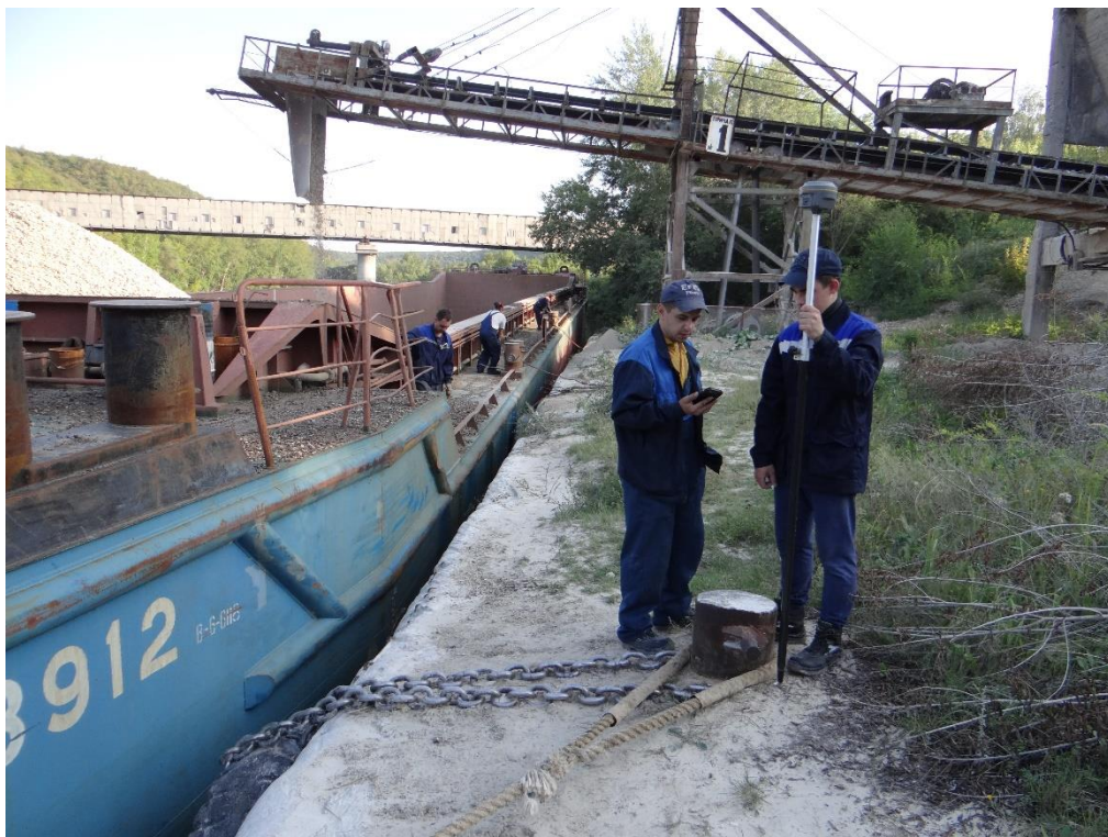
Съемка территории причала спутниковым GNSS-приемником
