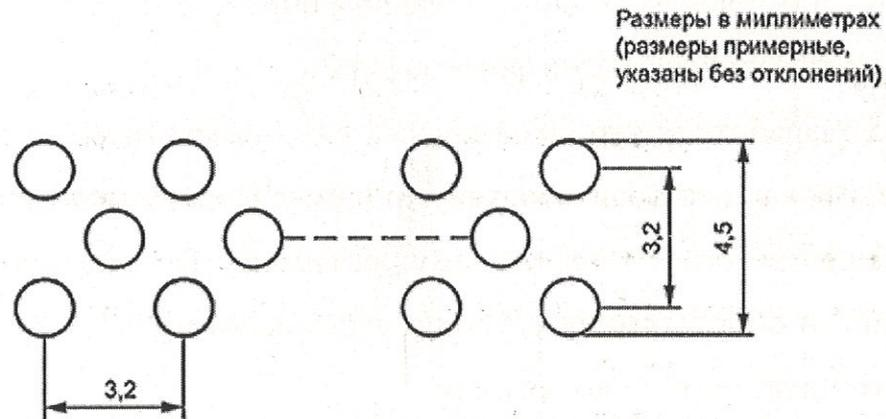
Примечание - Круглые отверстия диаметром 1,32 мм с расстоянием между центрами 3,2 мм, расположены ступенчато в три ряда по фронтальной поверхности горелки. Номинальная длина фронтальной поверхности горелки - 500 мм.
