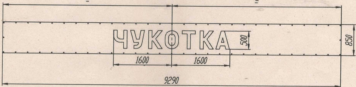
Рис.2 Схема расположения надписи на обвесе пр. 22220 зав. N°05712
