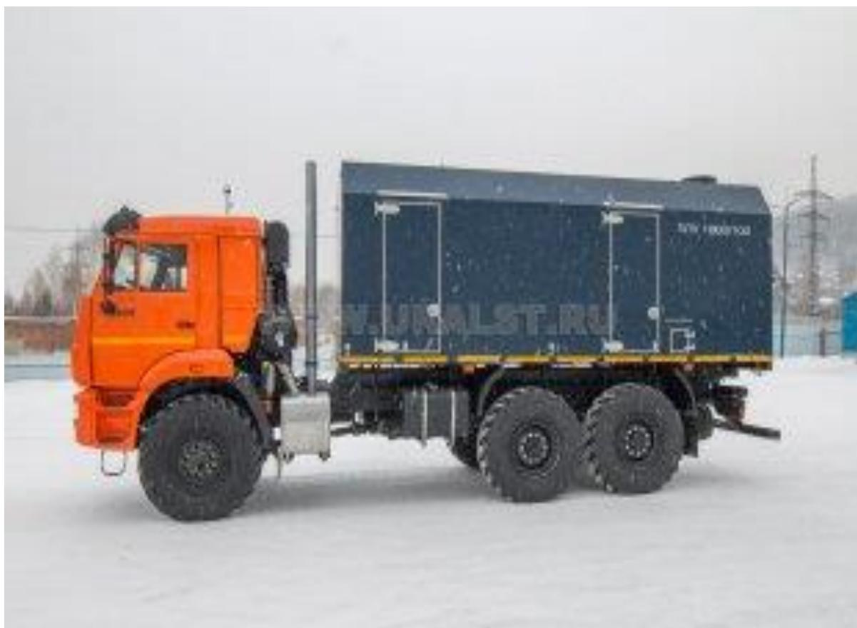
Паровая промышленная установка 1600/100, насос 2,3 ПТ, заднее расположение котла, пульт управления в кабине водителя, 6x6, 340 л.с., дв. Cummins, КП ZF9, спальное место
