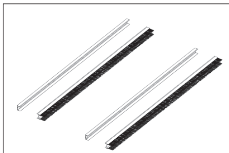
8. Верхний алюминиевый профиль и нижний алюминиевый профиль с щеточным уплотнителем
