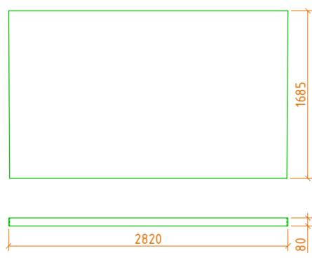
1. Перегородки выполняются из бетона с армированием аналогично ТП.
