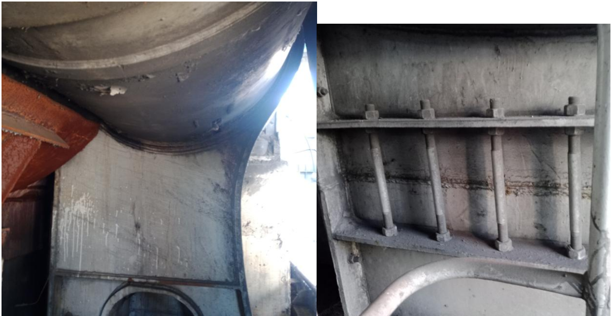
Рис. 3.2 Сварные швы и болтовые соединения центрального вала
