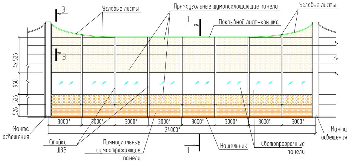
Секция шумозащитных конструкций. Тип 2.
