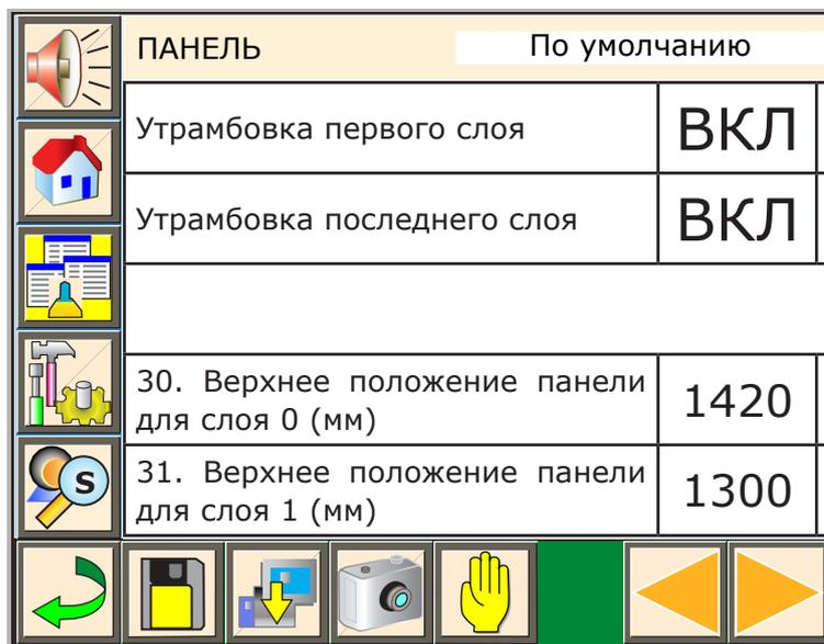
**УТРАМБОВКА ПЕРВОГО СЛОЯ:** позволяет выбрать, нужно ли подвергать вертикальной утрамбовке первый слой на заполняемом паллете (ВКЛ/ВЫКЛ).
